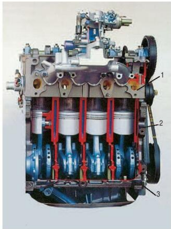
Hình 22.1. Sơ đồ cấu tạo thân máy, nắp máy
