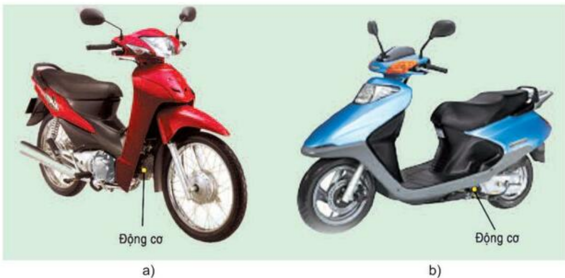
Hình 34.2. Bố trí động cơ trên xe máy
